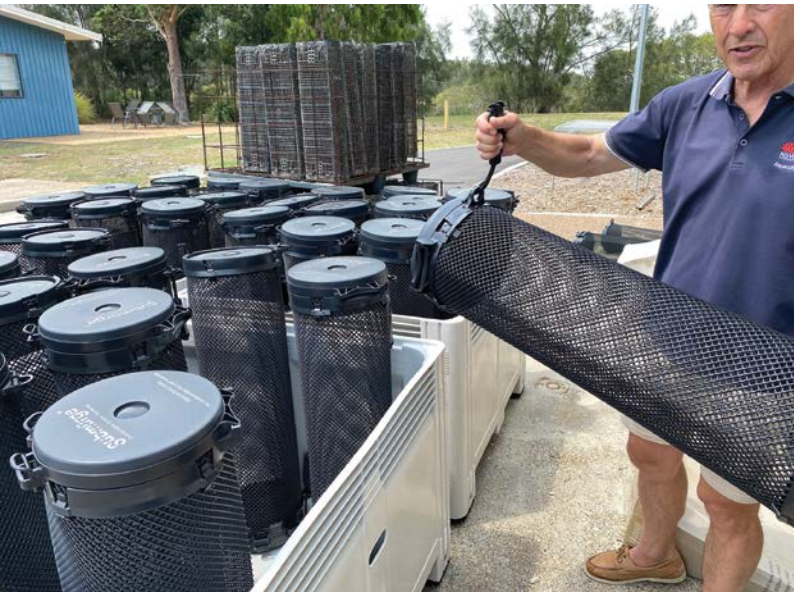
Az osztrigatermelés technológiai fejlesztése az intézet egyik fő feladata. A kifejlesztett ketrecek az osztrigák munkaerő-takarékos forgatására szolgálnak (Fotó: Horváth Ákos)
