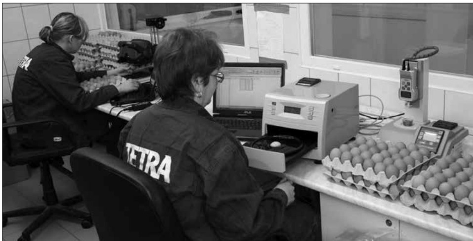
Tojásmínőség vizsgálatok (héjszín, sűrűfehérje magassága és HU index, héjszilárdság) (1)
