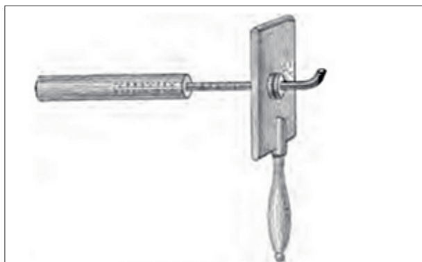
Figure 1. Zwaardemaker's olfactometer (Zwaardemaker, 1895)
